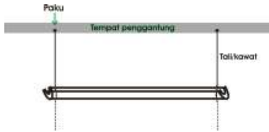
Gambar 9. Pemasangan media ke tempat penggantung
